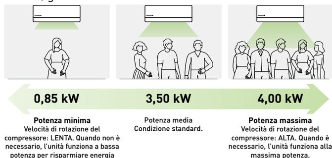
\* Il grafico mostra l'ampio intervallo di potenza in uscita del modello ad Inverter da 3,5 kW in raffreddamento.
